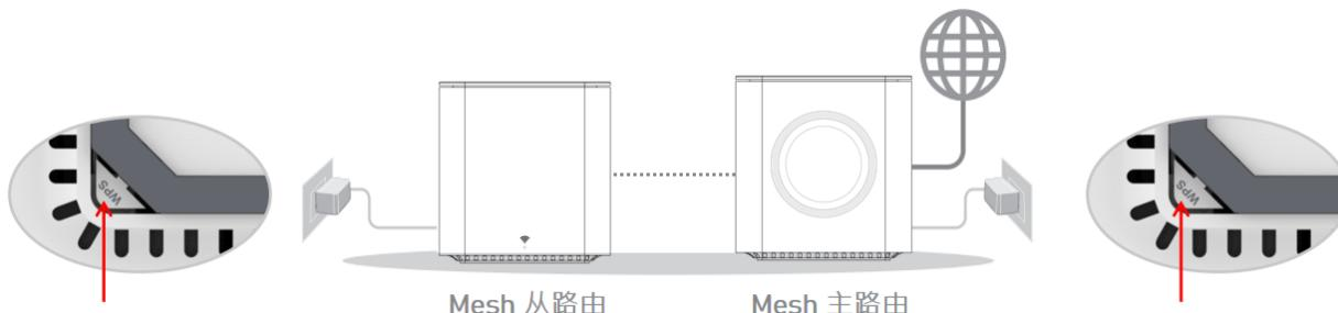
任意型号的主从路由设备，同时在设备底部按下 WPS 按钮，设备将自动扫描并连接。
