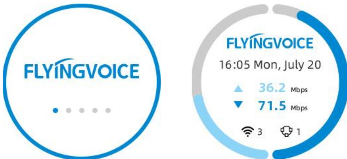
您在待机界面，可查看时间、瞬时上下行网速、无线接入终端设备数量、Mesh 组网的从设备数量。向右滑动，可查看 WAN 口 IP 地址和路由器 IP 地址，若您 WAN 口未连接调制解调器，则无法查看。
